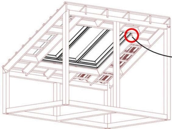
Encoche pour l'emboîtement d'une panne 36 x 147 mm avec double lattage permettant l'insertion du VELUX Verrière 1880 x 1180 mm
